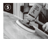
推奨工具 APE201/京セラ製 中間クッションパッド 170Φ(M119) ナイロン強力パッド 180Φ(M029)
